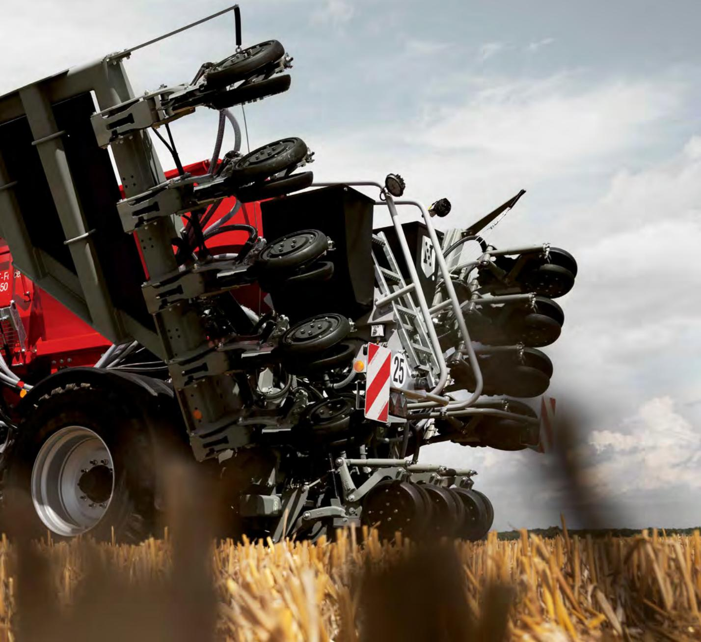
— Pure Kraft, exakt dort, wo sie gebraucht wird. Novag T-ForcePlus Direktsaatmaschinen können ihren Anpressdruck automatisch und in Echtzeit an den tatsächlichen Bodenwiderstand anpassen.
