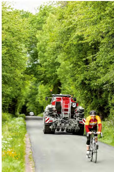
**Die schmale Transportbreite von drei Metern sorgt für einen schnellen und sicheren Transport. Die klappbaren Seitenflügel werden automatisch mit einem Haken verriegelt.**
