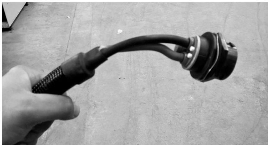
Abb. 14 : Batteriekabel mit Steckdose für den Anschluss der Maschine
