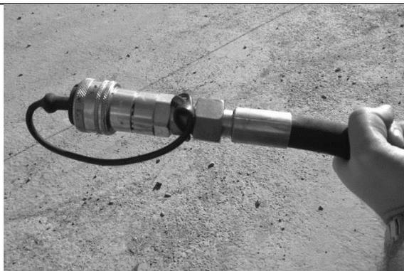
Abb. 23 : Beispiel für zusätzlichen drucklosen Rücklauf am Traktor      Abb. 24: Rücklaufschlauch
