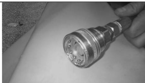
*Abb. 45 : Bremsleitung mit spezieller Kupplung für hydraulische Bremse*
