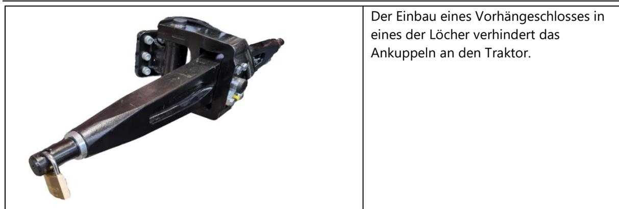
Der Einbau eines Vorhängeschlosses in eines der Löcher verhindert das Ankuppeln an den Traktor.
