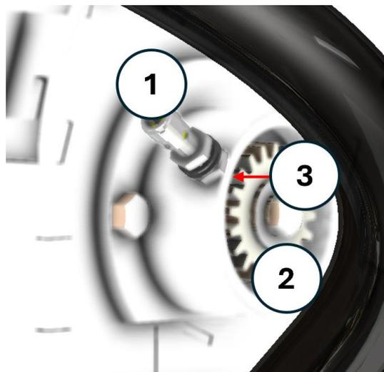
Abb. 51 : Drehzahlsensorik
