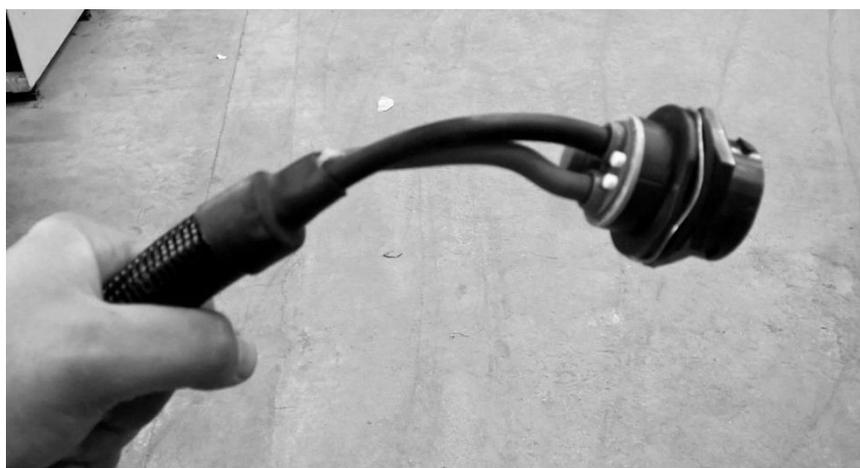
Abb. 13 : Batteriekabel mit Steckdose für den Anschluss der Maschine
