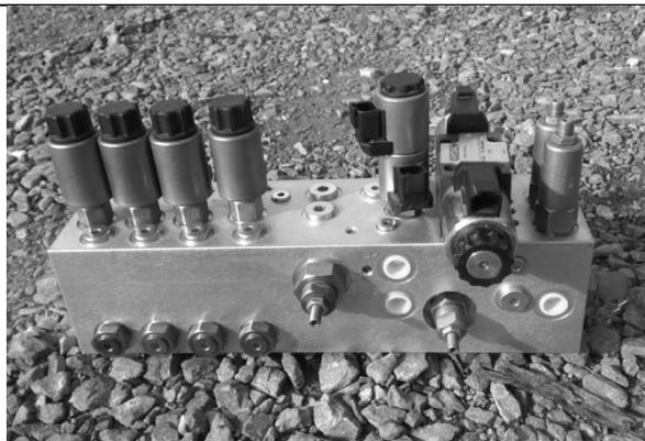
Abb. 76 : Haupthydraulikblock
