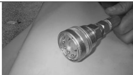
*Abb. 42 : Bremsleitung mit spezieller Kupplung für hydraulische Bremse*
