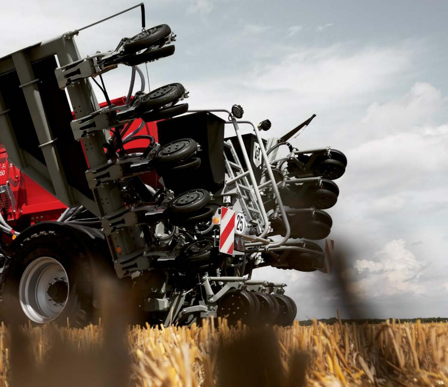
— Pure Kraft, exakt dort, wo sie gebraucht wird. Novag T-ForcePlus Direktsaatmaschinen können ihren Anpressdruck automatisch und in Echtzeit an den tatsächlichen Bodenwiderstand anpassen.
