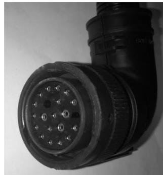
*Fig. 15 : Prise Cabine sur Faisceau Semoir*
