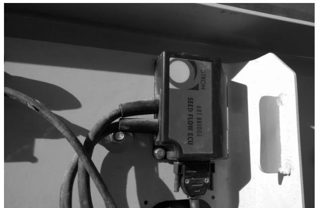
Fig. 34 : Boîtier ISOBUS du contrôleur de semis installé dans le coffret électrique
