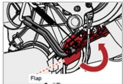
Fig. 38 : Trappe de calibrage
