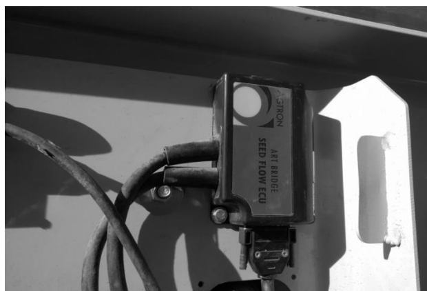
Fig. 35 : Boîtier ISOBUS du contrôleur de semis installé dans le coffret électrique
